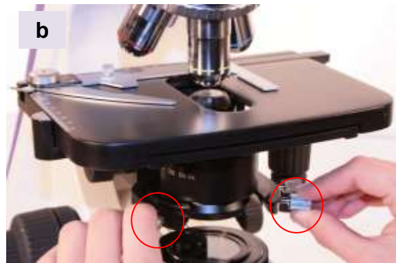
Figure 2 : La molette située sur la gauche du condenseur (a) permet de régler la hauteur de ce dernier afin d'obtenir un polygone lumineux plus net et plus petit. Les vis de centrage (b) du condenseur permettent de centrer ce polygone dans le champ d'observation.
