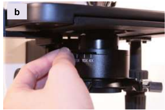
Figure 1 : Diaphragme de champ (a) qui contrôle la taille du champ éclairé sur l'échantillon, et diaphragme d'ouverture (b) dont l'ajustement est lié à l'objectif utilisé (comme vous pouvez le voir sur la photo sous la rainure des chiffres correspondant aux différents objectifs sont inscrits). Ce diaphragme d'ouverture permet de compenser le manque de profondeur de champ de certains objectifs.
