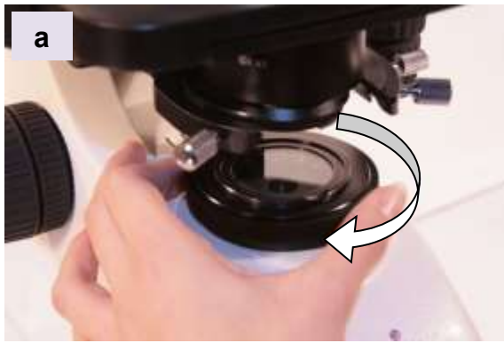
Figure 1 : Diaphragme de champ (a) qui contrôle la taille du champ éclairé sur l'échantillon, et diaphragme d'ouverture (b) dont l'ajustement est lié à l'objectif utilisé (comme vous pouvez le voir sur la photo sous la rainure des chiffres correspondant aux différents objectifs sont inscrits). Ce diaphragme d'ouverture permet de compenser le manque de profondeur de champ de certains objectifs.
