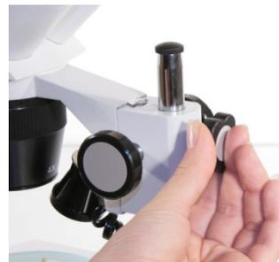
Faites une première mise au point à l'aide de la molette latérale (8) en gardant l'œil gauche fermé. Lorsque l'image est nette pour votre œil droit, fermez cet œil et affinez la mise au point pour l'œil gauche à l'aide de la bague de réglage dioptrique située sur l'oculaire gauche (1).
