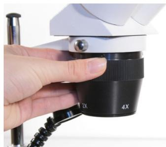
Vous pouvez régler la force nécessaire à la rotation de la molette de mise au point grâce à la clé fournie (cf. photo de droite).
