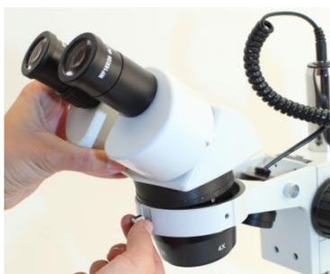
Placez la tête optique sur la potence et serrez la vis de blocage de la tête optique, comme indiqué sur la photo ci-contre.
