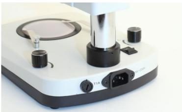
Cette loupe binoculaire est utilisable sur secteur 220 Volts 50 Hertz. Pour allumer les éclairages, mettez l'interrupteur sur la position 1 et tournez les bouton de réglage de l'intensité.
