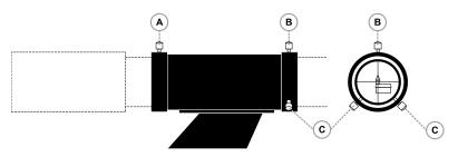
• Il faut maintenant aligner le chercheur, c'est à dire positionner l'image observée dans l'oculaire (12) au centre du réticule lorsqu'on regarde dans le chercheur (2). Jouez sur le serrage des vis du bas (C) pour positionner l'objet visé au centre du réticule. Lorsque le réglage est terminé, serrez légèrement la vis du haut (B) pour Maintenir le chercheur en position.
