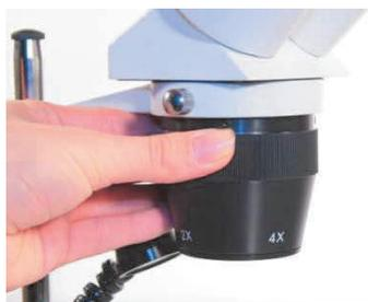
Vous pouvez régler la force nécessaire à la rotation de la molette de mise au point grâce à la clé fournie (cf. photo de droite).
