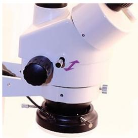
Lorsqu'une caméra est montée sur la sortie « trinoculaire » (1) il est nécessaire de manipuler la tirette située sur la gauche (à côté de la molette de mise au point). Elle permet de dévier, vers la caméra, le faisceau lumineux normalement dirigé vers les oculaires. Vous pouvez ainsi basculer à loisir entre des observations directes via les oculaires et des observations indirectes via la caméra.
