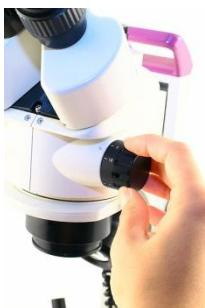
Placez le spécimen à observer sous l'objectif et, fixez-le à l'aide des pinces valets si nécessaire (modèles 6-45C et 6-45L). Placez vos yeux à plus d'un centimètre des oculaires (4) et réglez l'écartement inter-pupillaire (correspondant à l'écartement de vos yeux) de manière à ne voir qu'un seul cercle dans le champ de vision.
