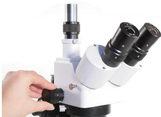
Pour adapter l'instrument à votre vue, vous pouvez effectuer un réglage dioptrique : Fermez un des deux yeux, et faites la mise au point pour celui-ci à l'aide des molettes macro et micrométriques (image de droite ci-dessous). Inversez ensuite l'ouverture de vos yeux et ajuster la netteté pour le second œil à l'aide de la molette de réglage dioptrique correspondante (image de gauche ci-dessous). Lorsque ce réglage est terminé, vous pouvez le fixer grâce à la vis de blocage du réglage dioptrique
