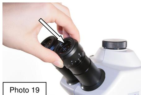
Pour une observation plus confortable, installez les bonnettes fournies avec la loupe en retirant les joints en caoutchouc présents sur les oculaires (photo 20) et en insérant à leur place, dans la rainure prévue à cet effet, les bonnettes (photo 21).
