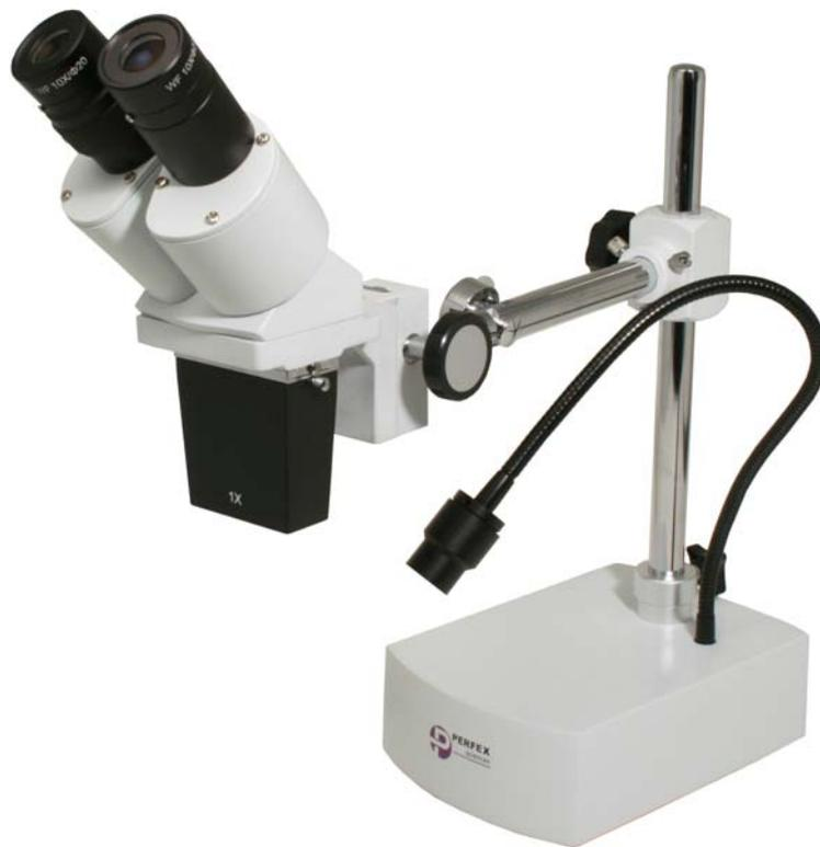
Cette loupe a été spécialement conçue pour l'observation des objets volumineux ou pour effectuer des travaux minutieux tels que la réparation et le contrôle des cartes électroniques, l'horlogerie, la bijouterie ou le contrôle qualité. Elle est très pratique grâce à sa grande distance de travail (23 cm à 10x) et de profondeur de champ couplée à un son système d'éclairage à LED orientable et son lourd pied assurant sa stabilité.
