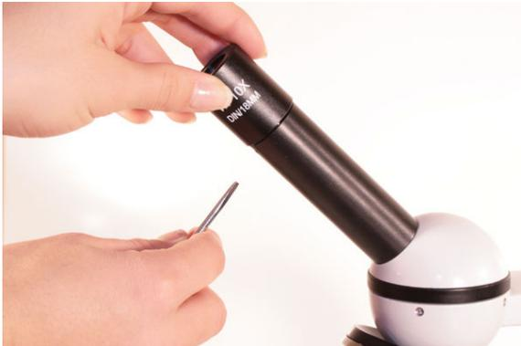
Dévissez la vis, sans la retirer, située sur le tube optique sous l'oculaire comme indiqué sur la photo, jusqu'à ce que l'oculaire puisse être sorti.
