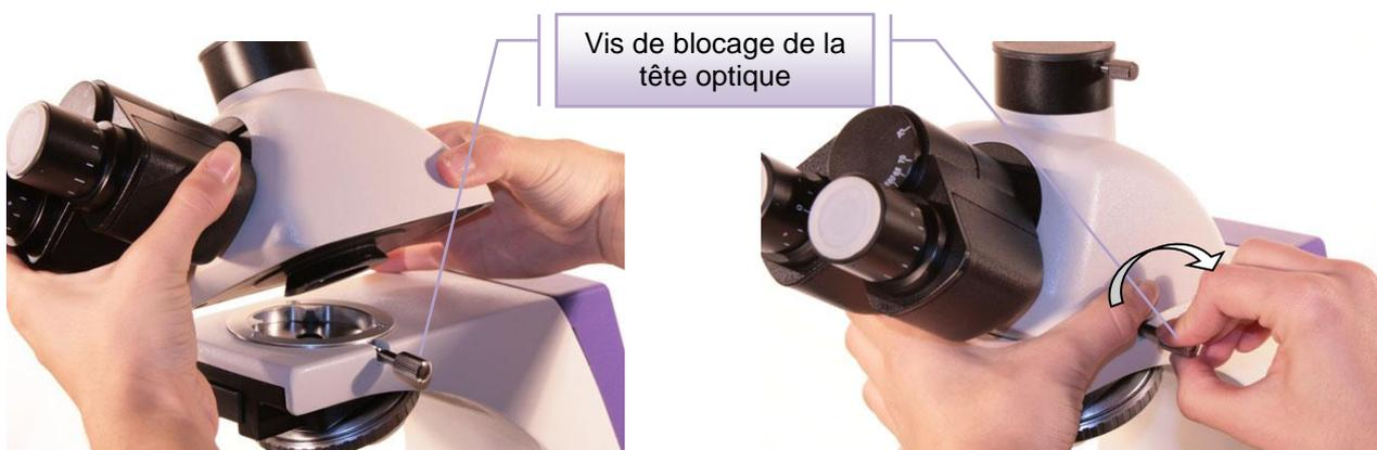
Une fois la tête optique installée, retirez les caches présents au niveau des tubes optiques (photo de gauche ci-dessous) et insérez à cet endroit les oculaires (photo de droite ci-dessous).
