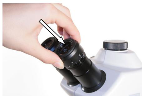
Pour une observation plus confortable, installez les bonnettes fournies avec la loupe en retirant les joints en caoutchouc présents sur les oculaires et en insérant à leur place, dans la rainure prévue à cet effet, les bonnettes.
