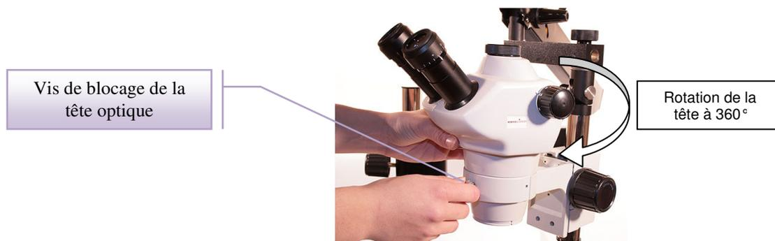
Une fois la tête optique installée retirez les caches présents au niveau des tubes optiques et insérez à cet endroit les oculaires (1). N'hésitez pas à forcer un peu pour les rentrer correctement dans leur emplacement (mais attention au réglage dioptrique (2), cf paragraphe D).
