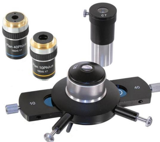
Premièrement, enlever le condenseur présent, puis le remplacer par le condensateur spécial. Pour le positionner correctement, remonter la platine au maximum, en s'assurant de ne pas toucher les objectifs. Une fois introduit, le fixer grâce à la vis de serrage.
