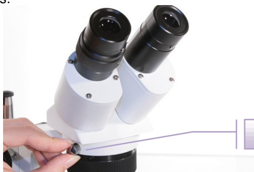
Vis de blocage de la tête binoculaire
